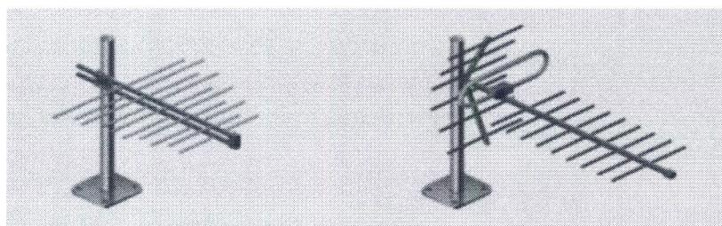
Оба типа принимают дециметровые волны – 21-60 телевизионные каналы (ТВК). Логопериодическая antenna выручает, если мультиплексы передаются на сильно удаленных друг от друга частотах. Например, если первый мультиплекс транслируется на 24 ТВК, а второй – на 58 ТВК. В случае, если разница между ТВК не более чем на 10-15 единиц, оптимальный выбор – antenna «волновой канал». Узнать ТВК мультиплексов в своем регионе можно на сайте ртс.рф.
